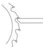
Az élező tárcsa helyzete a fog hátoldalának élezéséhez
