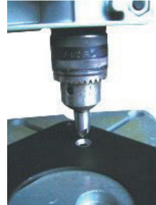
10. A megfelelő átmérővel kifúrt furatokba készítsen sülyesztést, hogy a csavarfej a lap síkja alatt legyen. Ha a csavarfej kiáll a szerelőlap síkjából, akkor a felszerelt alsómáró tengelye nem lesz merőleges az asztallapra.
