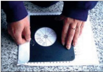
6. A sablonra helyezze rá az asztal tartozékát, a szerelőlapot. Ügyeljen arra, hogy a szerelőlap a berajzolt vonalon legyen.
