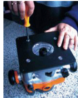
11. A szerelőlapot rögzítse a felsómárón 4 darab csavar segítségével.
